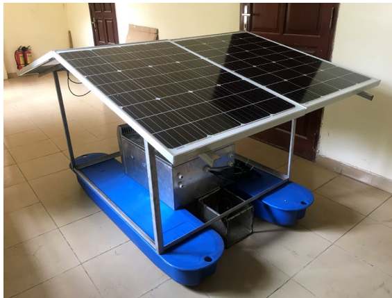
Hình 6. Mô hình trạm đo trên mặt nước.
